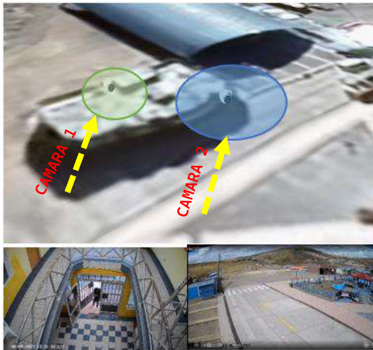
Figura 13. Primer punto de instalación de las cámaras de seguridad interna
